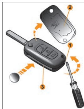
Рис. 10. Замена элемента питания пульта дистанционного управления
