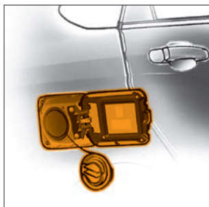
Рис. 5. Крышка люка и пробка наливной горловины топливного бака
