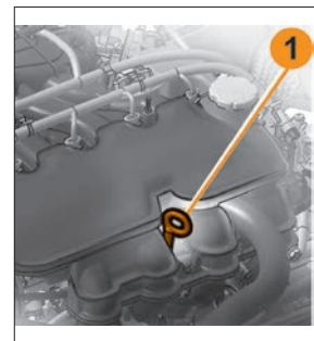
Рис. 4. Проверка уровня масла в картере двигателя
