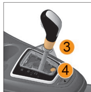
Рис. 21. Снятие блокировки рычага переключения передач
