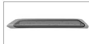
Рис. 16. Дополнительный сигнал торможения (кузов «SW»)
