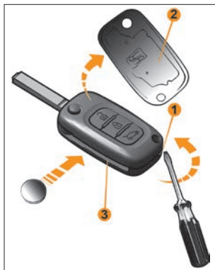
Рис. 10. Замена элемента питания пульта дистанционного управления
