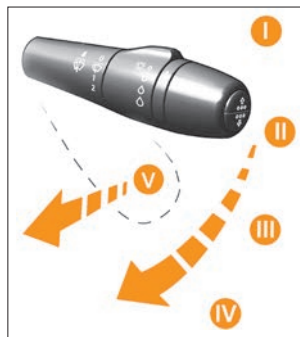
Рис. 17. Рычаг переключателя стеклоочистителей
