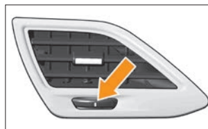
Рис. 8. Боковое левое сопло вентиляции салона (рукоятка управления заслонками сопла в положении «ЗАКРЫТО»)
