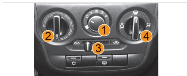
Рис. 37. Блок управления системой вентиляции и отопления
