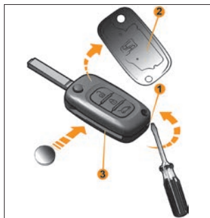
Рис. 52. Замена элемента питания пульта дистанционного управления
