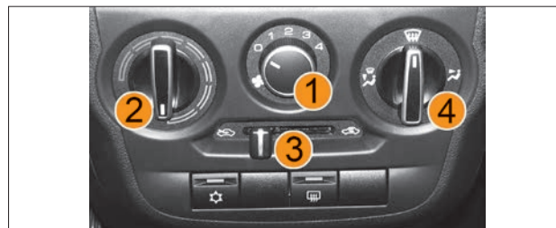
Рис. 37. Блок управления системой вентиляции и отопления
