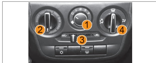
Рис. 37. Блок управления системой вентиляции и отопления
