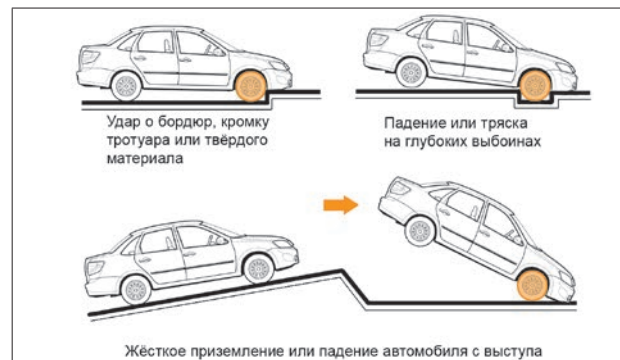
Рис. 15б. Примеры ситуаций со срабатыванием системы пассивной безопасности водителя и переднего пассажира
