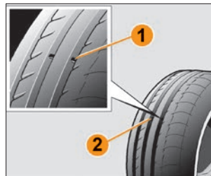
Рис. 6.9.4. Выступы-индикаторы на шинах
