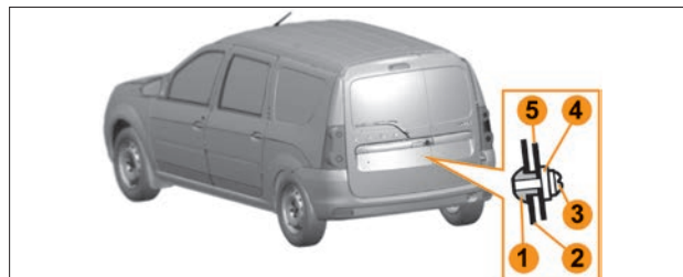
Рис. 5.1.2. Установка заднего номерного знака
