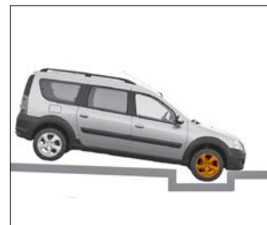
Рис. 2.6.7. Пример ситуации с возможным срабатыванием фронтальных подушек безопасности при падении или тряске на глубоких выбоинах
