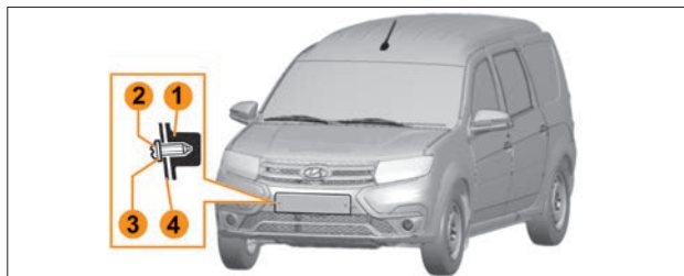
Рис. 5.1.1. Установка переднего номерного знака
